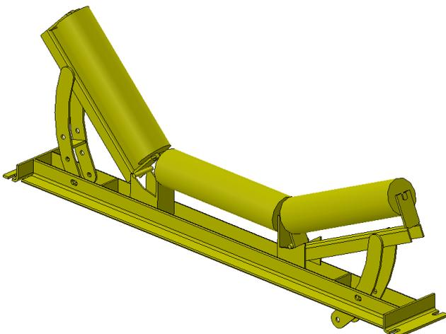
O cavalete ajustável é utilizado imediatamente a frente do chute. Sua função é realizar o apoio da correia na transição da parte plana (tambor) para a parte curvada (rolos dos cavaletes) onde há a formação do “coxo”. A quantidade pode variar mas usualmente são utilizados cerca de 3 cavaletes ajustáveis.
